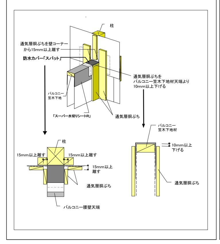
防水カバー「スパット」は基本使用及び左片折り曲げ使用/右片折り曲げ使用/両折り曲げ使用と、 バリエーションに富んだ使い方ができます。
